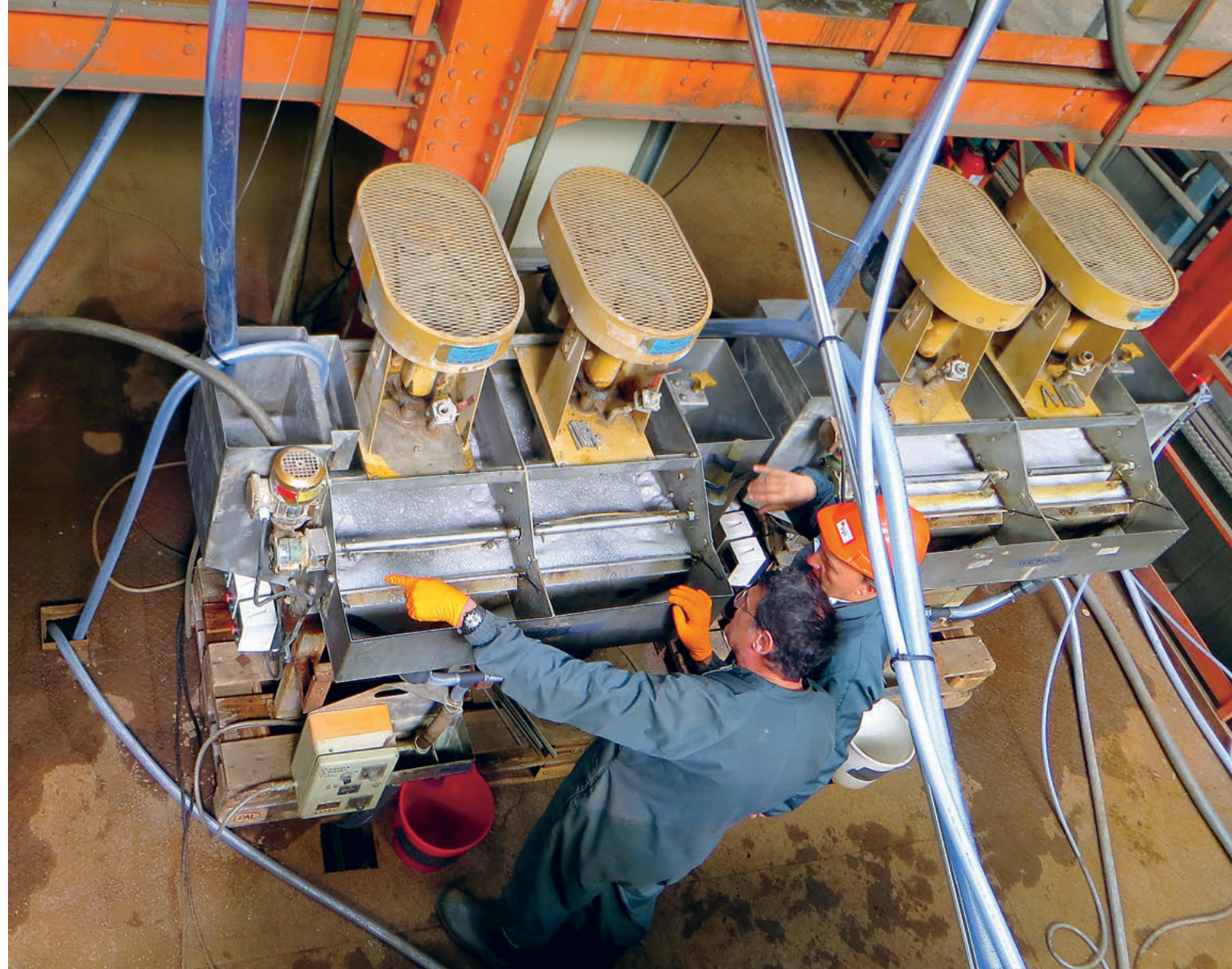
Cellules de flottation. Halle d'essais minéralurgiques du BRGM (projet ENVIREE). © BRGM
