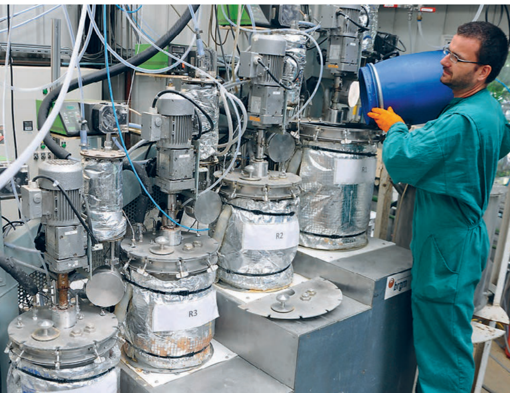
Suivi expérimental sur un pilote de biolixiviation. Le BRGM a été précurseur dans l'exploitation des potentialités de la biolixiviation pour libérer les métaux encore présents dans les déchets miniers. © BRGM - Pauline d'Armancourt
