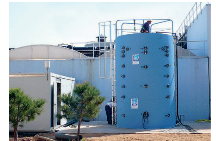
Réacteur de suivi du pouvoir d'épuration des sols sur un pilote expérimental REUSE - Recyclage des eaux. Ici, une colonne de sol constituée avec infiltration d'eau usée traitée et monitoring par bougies poreuses. © BRGM
